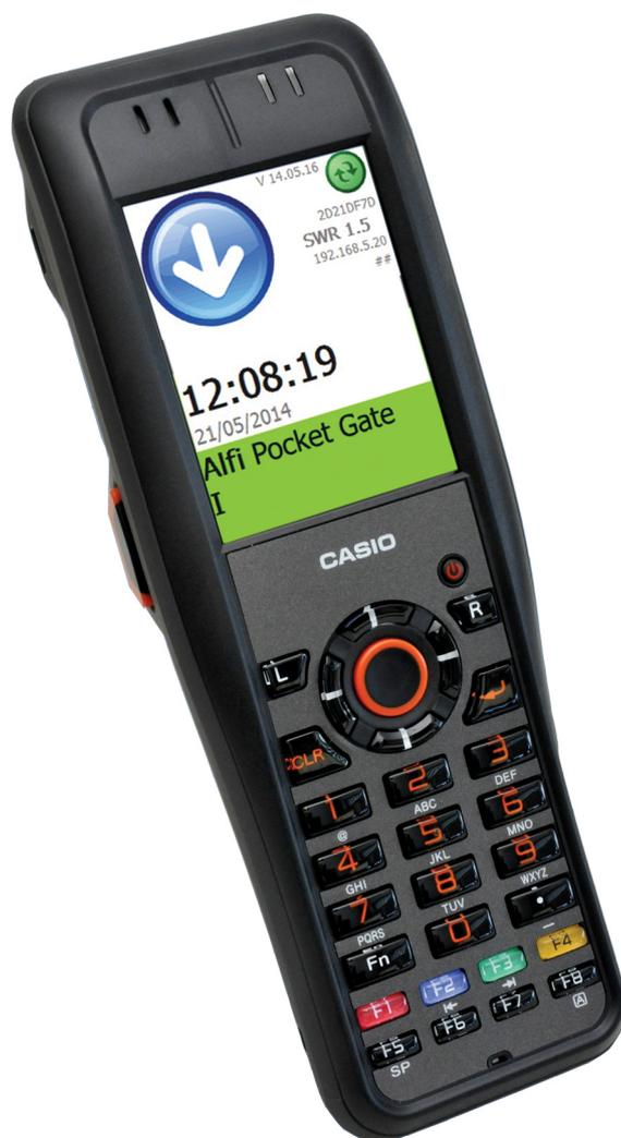
Pocket Gate è una soluzione comoda e robusta per il controllo degli accessi con operatore negli impianti di risalita, da affiancare ai tradizionali varchi fissi. Pocket Gate è un varco palmare che può operare in due modalità: monitoraggio, per la verifica dei titoli d'accesso, e obliterazione, per la convalida.
